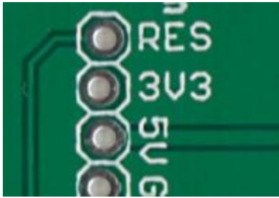
Gambar 11. Jejak kecil yang menghubungkan tombol Reset ke tempat lain di papan. Jejak yang lebih besar dan lebih tebal terhubung ke pin daya 5V.
