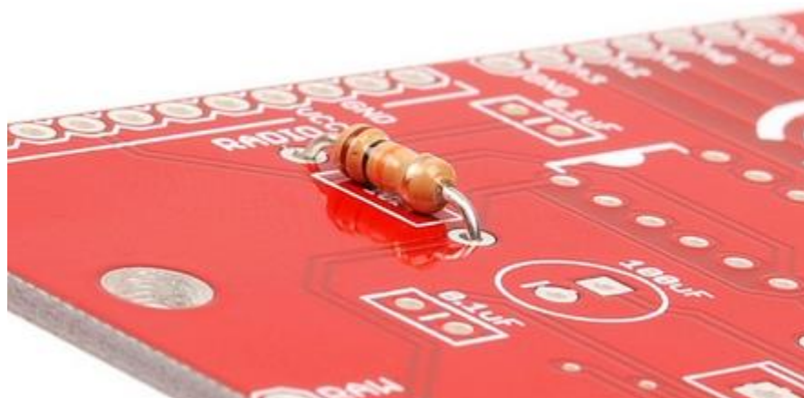
Gambar 10. Sebuah resistor PTH dimasukkan ke PCB FabFM, siap untuk disolder. Kaki resistor melewati lubang. Lubang berlapis dapat memiliki jejak yang terhubung dengannya di bagian depan PCB dan bagian belakang PCB.
