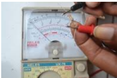
Gambar 1.17 Cara Pengukuran Resistor
