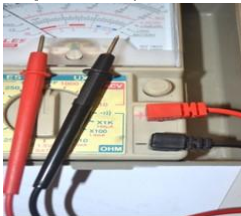
Gambar 1.13 Cara Pemasangan Probe Multimeter
