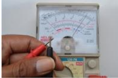
Gambar 1.15 Menghubungkan probe multimeter
