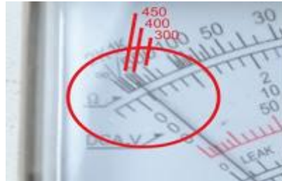
Gambar 1.18 Membaca multimeter melalui jarum penunjuk
