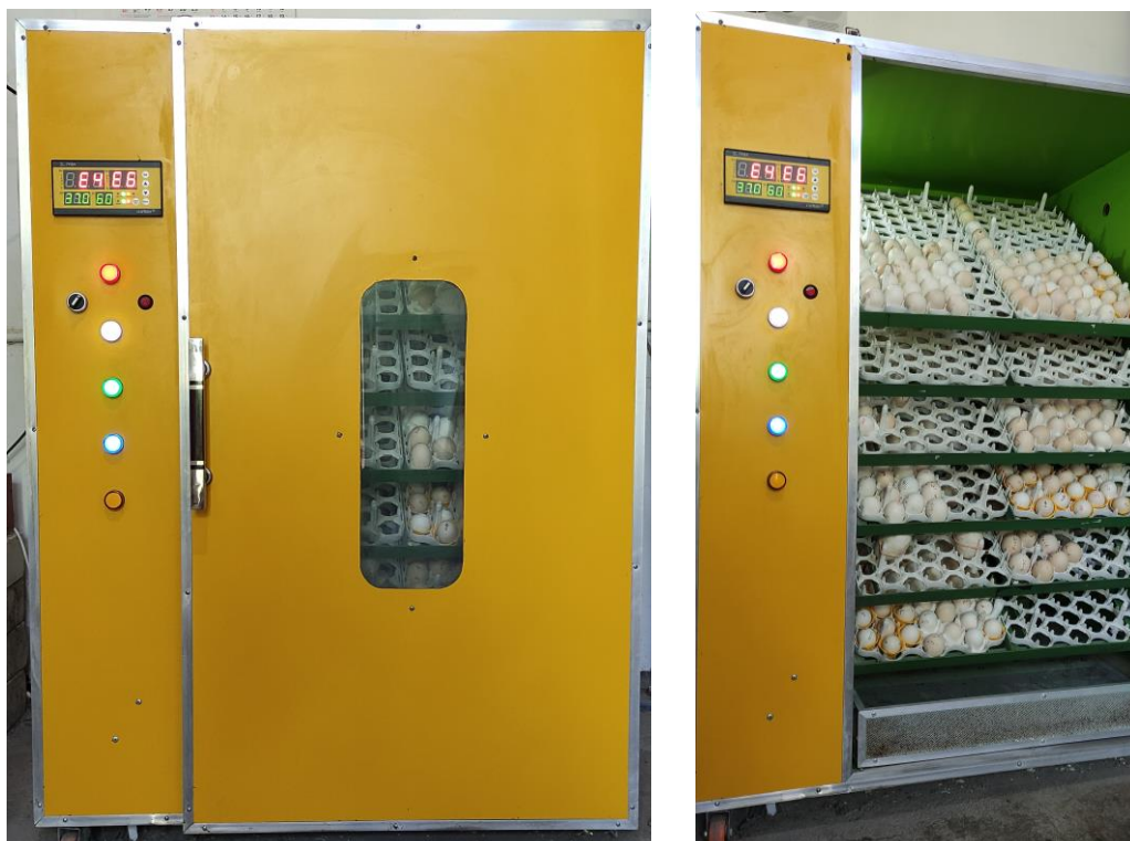
Gambar 3. Mesin semi otomatis kapasitas 1000 butir telur ayam
