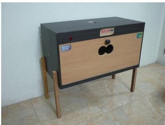
Gambar 2. Contoh mesin tetas sederhana kapasitas 100 butir telur.
