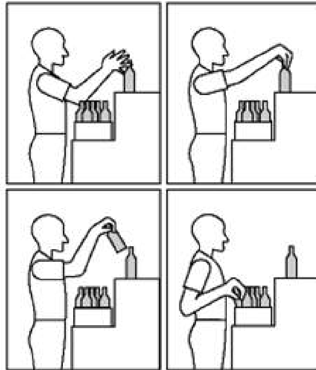
Gambar 4. Pada proses pengemasan botol, terdapat beberapa siklus gerakan, yaitu mencapai, menggenggam, memindahkan, dan menempatkan botol ke dalam kotak.
